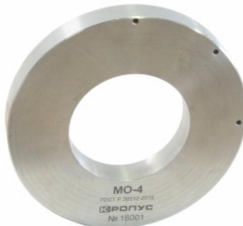
1, 2 - поверхностные дефекты; 3 - подповерхностные дефекты - три отверстия диаметром 2,5 мм, расположенные от цилиндрической поверхности на глубине 2, 3 и 4 мм
