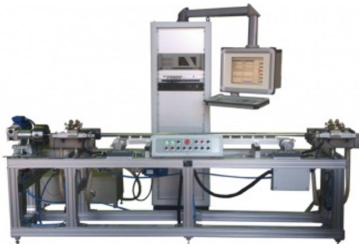
Установка предназначена для контроля качества кольцевых сварных соединений на трубах из нержавеющей стали диаметром 36 мм с толщиной стенки 5 мм.
