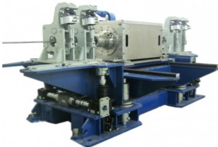
Установка УКВ-90 предназначена для высокопроизводительного (до 1м/сек) неразрушающего ультразвукового контроля бесшовных труб на наличие дефектов типа нарушение сплошности и однородности металла, измерения толщины стенки, наружного и внутреннего диаметра труб на металлургических и машиностроительных предприятиях. Метод контроля - ультразвуковой иммерсионный.
