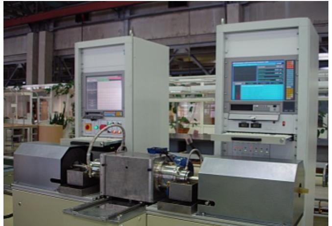
Установка УКВ-50 предназначена для неразрушающего ультразвукового контроля бесшовных труб на наличие дефектов типа нарушение сплошности и однородности металла, измерения толщины стенки, наружного и внутреннего диаметра труб на металлургических и машиностроительных предприятиях. Метод контроля - ультразвуковой иммерсионный.
