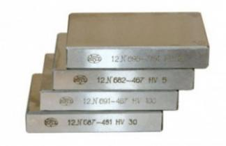
Меры твёрдости эталонные применяются при калибровке и поверке приборов для измерения твёрдости металлов по методу Виккерса (ГОСТ 2999-75) в лабораторных и цеховых условиях. Меры твёрдости эксплуатируются с твердомерами всех типов: стационарными, переносными и портативными.
