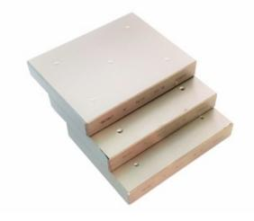
Меры твёрдости Бринелля применяются при калибровке и поверке приборов для измерения твёрдости металлов по методу Бринелля (ГОСТ 9012-59) в лабораторных и цеховых условиях. Меры твёрдости эксплуатируются с твердомерами всех типов: стационарными, переносными и портативными.
