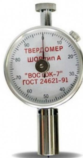
Твердомер предназначен для измерения значений твёрдости низко модульных материалов в единицах Шора методом вдавливания.
