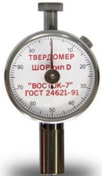
Твердомер предназначен для измерения значений твёрдости низкомодульных материалов в единицах Шора методом вдавливания.
