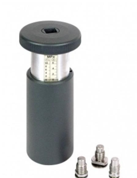
Механический адгезиметр предназначен для определения адгезии лакокрасочных и других покрытий между слоями и с основанием, а также когезии материалов по методу отрыва. Определяется удельное усилие, необходимое для отрыва покрытия от подложки, либо для когезионного разрушения покрытия.
