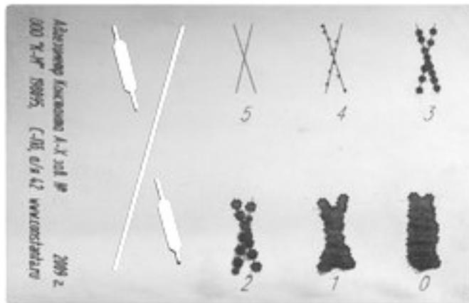
Адгезиметр укладывается на испытуемую поверхность, покрытие прорезается ножом-оритвой до подложки (выполняется Х-образный надрез), место разреза очищается щеткой или с помощью клейкой ленты-скотча, адгезия оценивается визуально по балльной системе.
