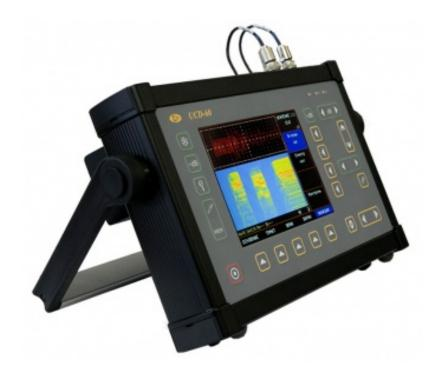
Многоканальный дефектоскоп УСД-60H-8К имеет восемь коммутируемых каналов, одновременно отображаемых на экране. Прибор предназначен, в основном, для непроизводительного контроля, такого как одновременное измерения скорости прохождения УЗК в разных точках изделий из шамотного стеклобруса, графита, камня и других материалов с большим затуханием при их исследования, разбраковки и пр.
