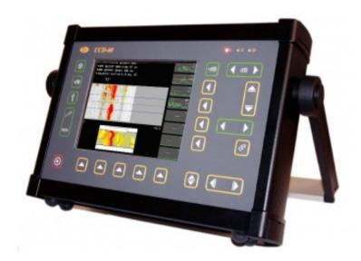
Восьмиканальный ультразвуковой сканер дефектоскоп УСД-60-8К WeldSpector предназначен для высокопроизводительного ручного ультразвукового контроля сварных швов. Применение современных цифровых технологий позволяет данному ультразвуковому дефектоскопу контролировать сварные соединения со скоростью до 4м/мин.
