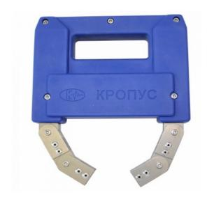
Новый революционный электромагнит KY-140 со встроенным Li-Ion источником питания, предназначен для проведения магнитопорошкового неразрушающего контроля с использованием постоянного магнитного поля. Обеспечивает возбуждение постоянного магнитного и максимальное удобство и мобильность оператора.
