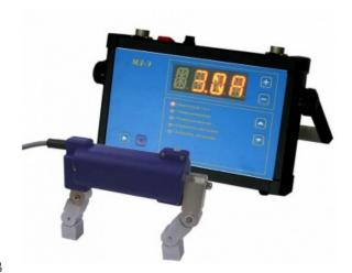
Новый электромагнит МД-Э - это универсальный инструмент для ручного магнитопорошкового контроля. НАличие электронного модуля управления позволяет регулировать ток намагничивания, сохранять настройки в памяти прибора, имеет режим "ток-пауза", автоматическое размагничивание, регулируемую длительностью намагничивания и размагничивания и другими функциями.
