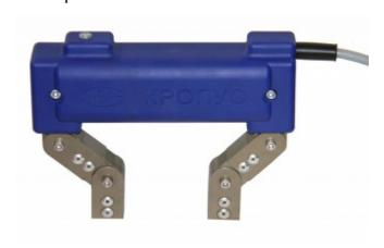
Обеспечивает возбуждение переменного магнитного поля при питании от сети 220В.
