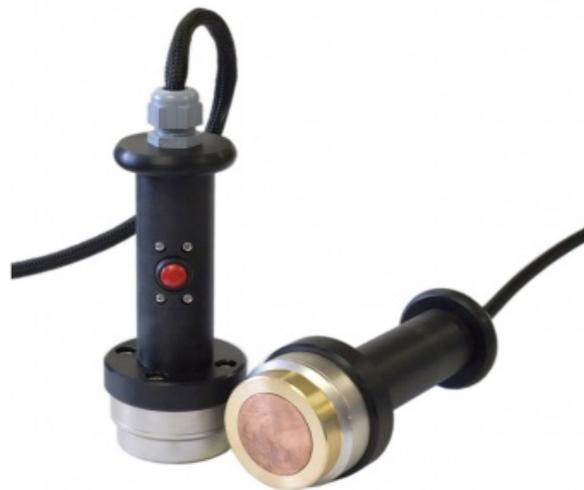
Магнитные электроконтакты предназначены для проведения неразрушающего контроля с помощью циркулярного намагничивания деталей из ферромагнитных материалов с относительной магнитной проницаемостью не менее 40.
