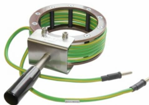
Катушка намагничивания для импульсных магнитопорошковых дефектоскопов МД-И, МДМ-2.
