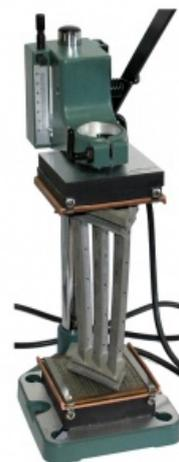
Штатив для циркулярного намагничивания небольших деталей из ферромагнитных материалов.
