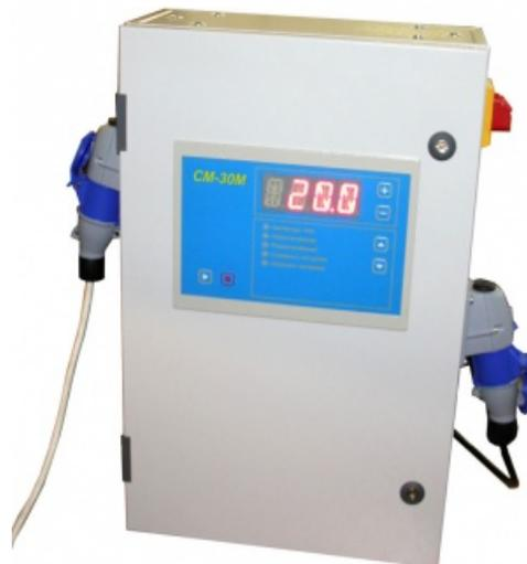
Намагничивающее устройство СМ-30М предназначено для создания в контролируемом изделии постоянного магнитного поля с помощью соленоида, а также размагничивания изделия убывающим магнитным полем меняющейся полярности. Дефектоскоп идеально рассчитан на работу с соленоидом Э600 с внутренним диаметром 600мм и позволяет создать в его центре поле напряженностью 350 А/см.
