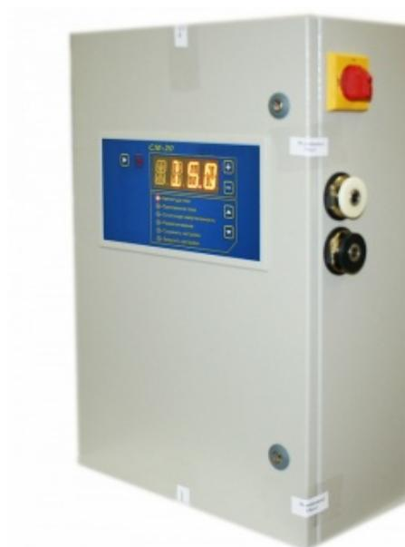
Импульсный магнитопорошковый дефектоскоп СМ-20 создан специалистами НПЦ "Кропус" как практичное и современное решение для цехового контроля поверхностных и подповерхностных дефектов в крупногабаритных изделиях. При массе всего 40 кг максимальная сила тока составляет 20кА!!!
