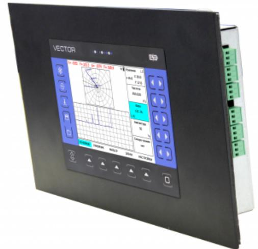
Новая модель вихретокового дефектоскоп ВЕКТОР версии 50П предназначена для автоматизации процесса вихретокового контроля. Дефектоскоп монтируется в любой промышленный шкаф и благодаря наличию дискретных входов и выходов интегрируется с любыми датчиками и исполнительными устройствами автоматической линии.
