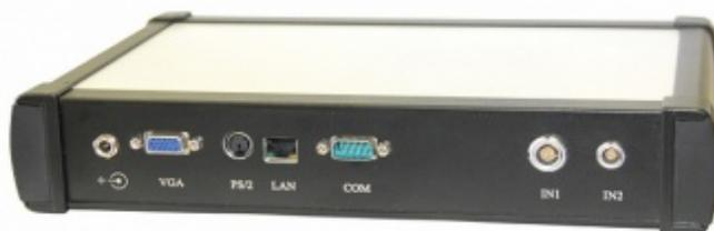
Вихретоковый дефектоскоп для автоматизированного и механизированного контроля ВЕКТОР версии 50А предназначен для автоматизации процесса вихретокового контроля в компактных установках. Дефектоскоп представляет собой программно управляемое устройство без экрана, передающее информацию по высокоскоростному интерфейсу Ethernet.
